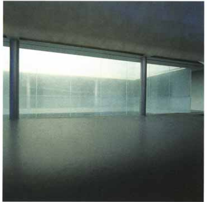
Teststrecke für das Raumlicht. Aufnahmen ab Modell 1:20 mit heruntergehängter Decke aus Glas. (Foto: Hans Danuser)
